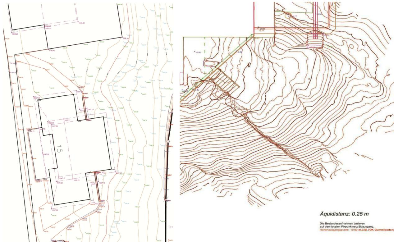
**3D-Geländemodelle:** Erstellung von Plangrundlagen durch Berechnung von digitalen Terrainmodellen inkl. Dachlandschaften und Überhängen sowie Höhenkoten, z.T. aus kombinierten Messverfahren wie bspw. Tachymeter und Laserscanner.
